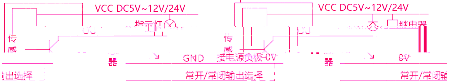
NPN信号输出： 连接指示灯的接线方法
